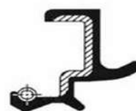
Figura 11-2(a): Vedação auxiliar mais resistente (contra agentes externos de grande porte) atuando sobre defletor metálico
