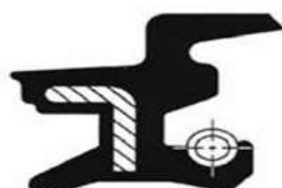
Figura 11-8(b): Vedação em eixo com movimento axial, como amortecedores de choque, da suspensão do veículo
