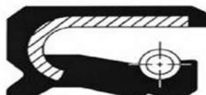
Figura 11-8(b): Vedação em eixo com movimento axial, como amortecedores de choque, da suspensão do veículo
