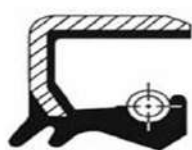
Figura 11-1: Um lábio de vedação principal e superfície externa metálica
